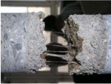
obr. 7 Vzorek po tahovém porušení
