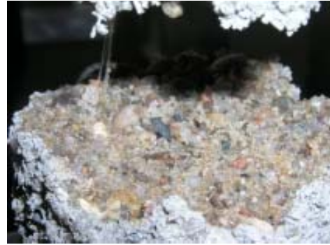
obr. 7 Vzorek po tahovém porušení
