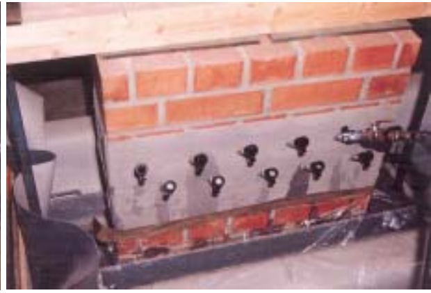
Obr.č. 6 – CarboCryl Wv – zkoušky provedení horizontální clony v cihelném zdivu proti vztlínající zemi vlhkosti
