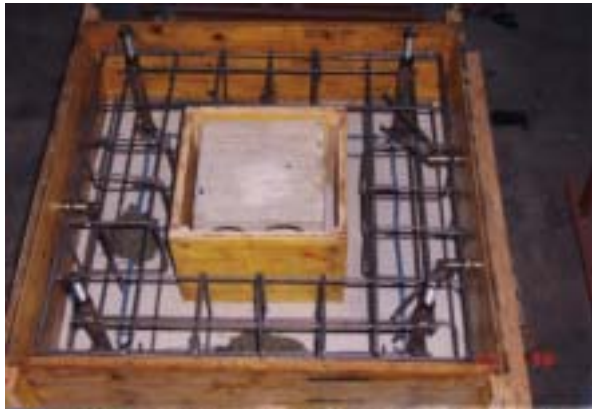
Obr.č. 7, 8 – CarboCryl T – zkoušky injektáže pracovní spáry monolitické betonové konstrukce přes injektážní hadici
