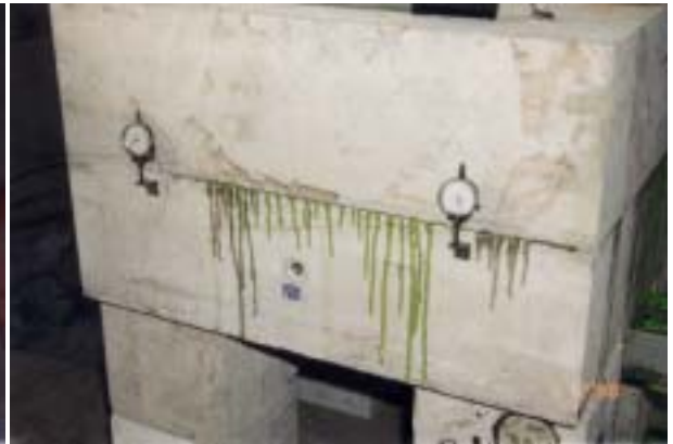
Obr.č. 7, 8 – CarboCryl T – zkoušky injektáže pracovní spáry monolitické betonové konstrukce přes injektážní hadici
